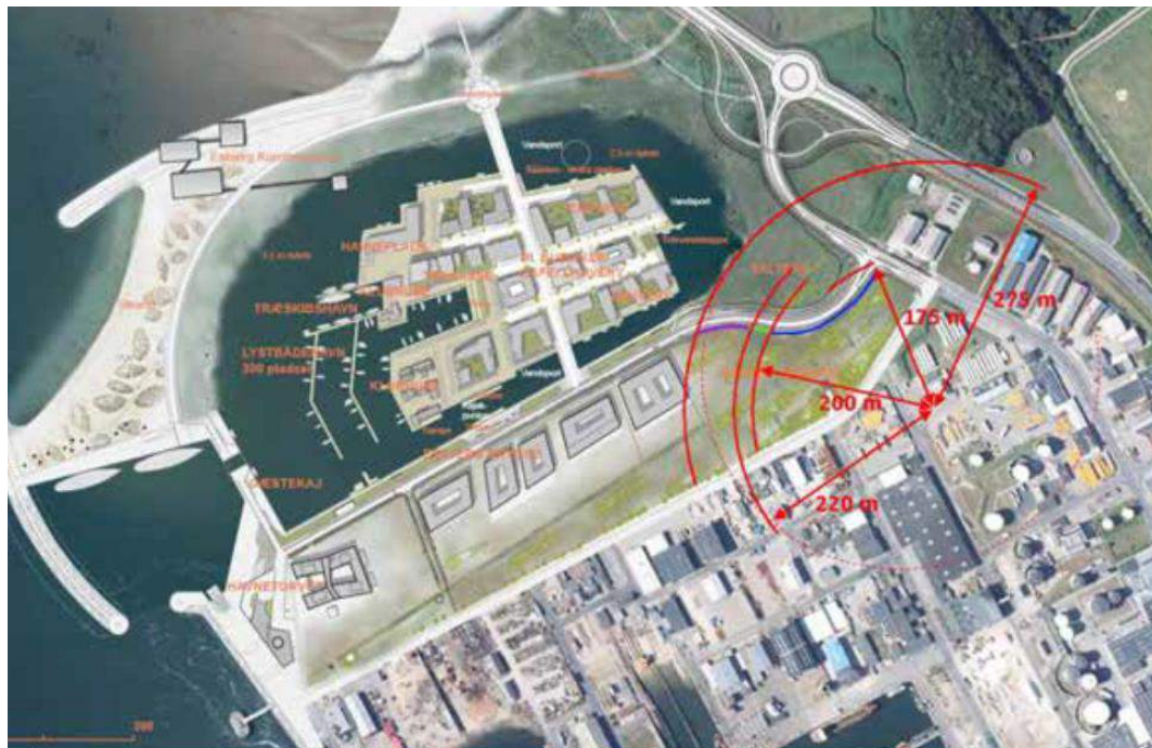
Figur 5-5 Kort med angivelse af 175 m (6 meter højdekrav), 200 m (6 meter højdekrav), 220 m (10 kW/m 2 ; 5 meter højdekrav) og 275 m (0,05 barg; 5 meter højdekrav) afstandene fra læssestationen på Kosan Gas A/S. Et oplæg til afskærmningsvæggen er indtegnet med blå for 6 meter højdekrav, grøn for 5 meter højdekrav og lilla for 5 meter højdekrav uden krav om varmestrålingsafskærmning.
